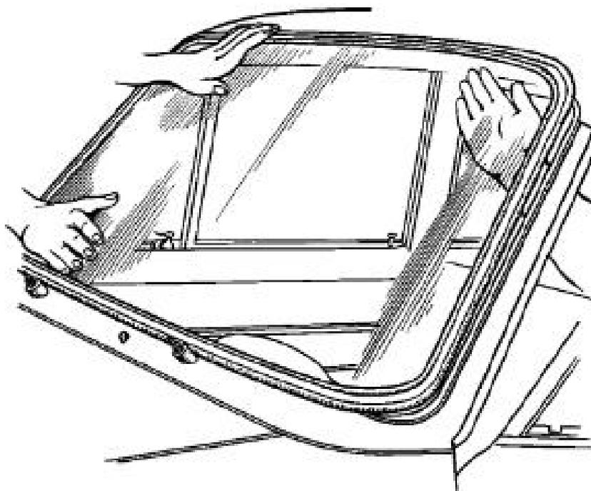
*Figure 1 Beispiel für das Entfernen der ursprüng Glasscheibe in einem Gummiprofil*
