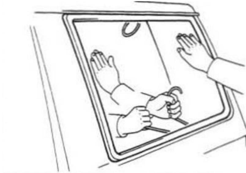
Figure 3 Entfernen der Schnur
